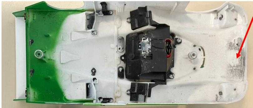
Elle doit être serrée sur le châssis. **Aucun jeu n'est toléré entre le châssis et les puits de la carrosserie.**
